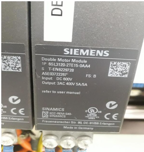
Imagen 2.3.- Especificaciones eléctricas de servodrive y servomotor
